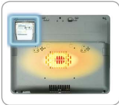
硬碟遠離主機板熱源,操作順暢 特殊硬碟保護設計,資料安全不遺失
